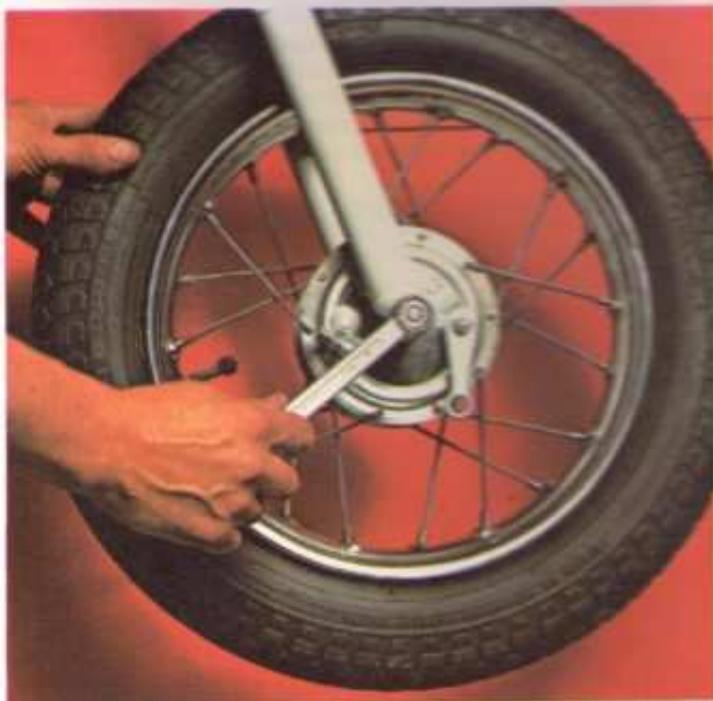
16. La longitud del eje de rueda debe permitir que las tuercas de sujeción se enrosquen con holgura, dejando aparecer la punta de dicho eje por ambos lados de la rueda. Las arandelas son de tipo "mariposa", y los retenes, imprescindibles.
