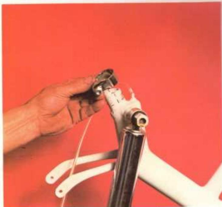
8. Una vez protegido el orificio de engrase, se necesita sujetar una corona para asentar el sillín. Esta corona debe tener excelente resistencia, porque debe evitar las deformaciones del cuello del tubo.
