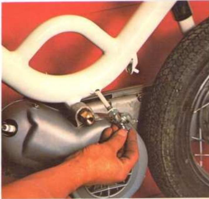
20. Claro está que si adoptasen la solución del tubo como depósito tendrían que prever un grifo de control del carburante sujeto en la misma parte baja del tubo-bastidor. Sin duda, existen muchas fórmulas al respecto.
