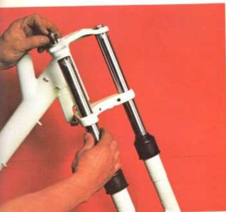
13. Si al colocar los rodamientos, cazoleta de dirección, guías, arandelas y demás piezas que componen la horquilla, encuentran resistencias anormales, deberían cambiar los componentes defectuosos. Sin vacilación.
