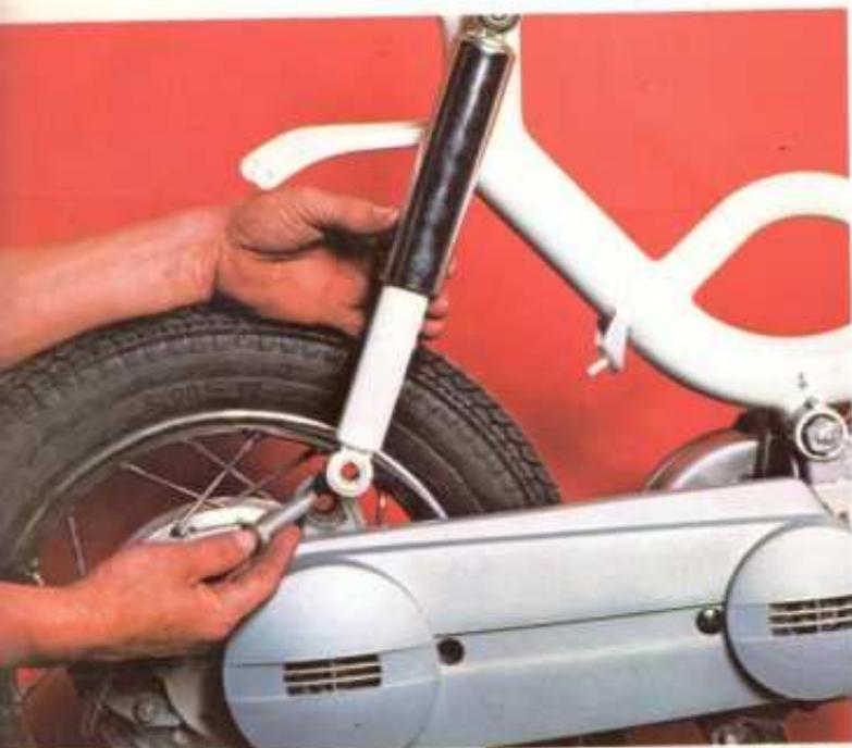
6. Aquí pueden ver el amortiguador sujeto por un eje que se coloca en la parte alta del bastidor. No cabe duda de que su dimensión y resistencia a la compresión debe armonizarse con el peso medio de los conductores.
