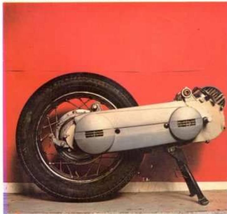
4. Aquí puede apreciarse el grupo propulsor del Vespino, base de la creación, acoplado ya con la rueda trasera del Mini-Ducati. Es obvio que ambas marcas pueden proporcionar los elementos de mayor interés para semejante máquina.
