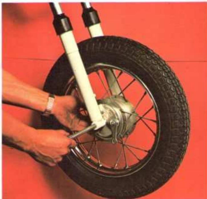
15. De nuevo la colocación del eje de rueda, apoyo de la horquilla, debe sugerir la máxima atención. Un eje imperfectamente recto **debe** cambiarse sin pensarlo. Es pieza relativamente barata que siempre conviene tener nueva.
